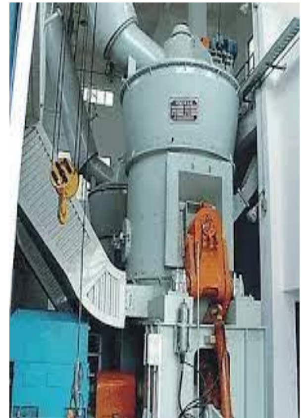
Macinazione verticale a cilindri d'acciaio
